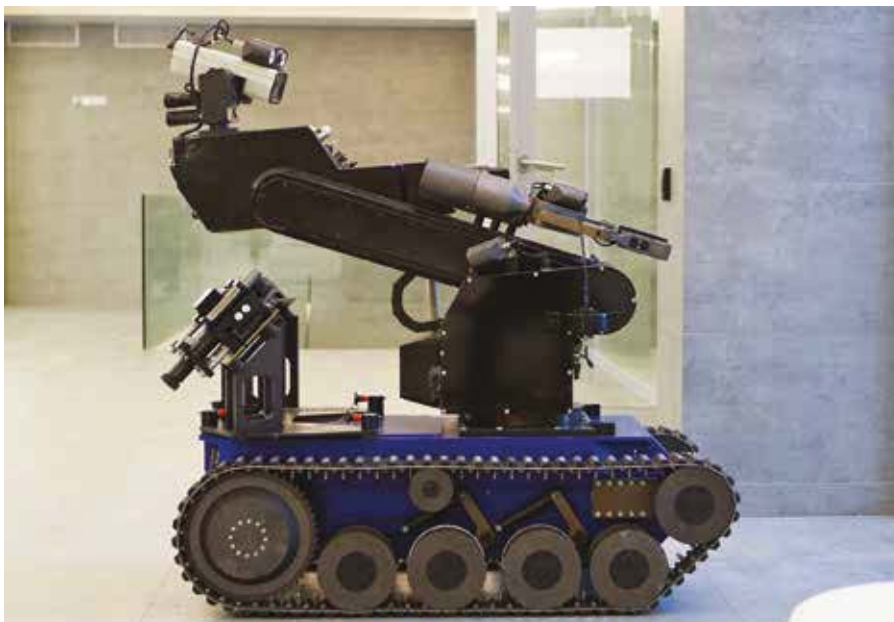
◀ Aby nedošlo k ohrožení lidských životů, pyrotechnici v nebezpečných situacích vysílají speciálního dálkově ovládaného robota
